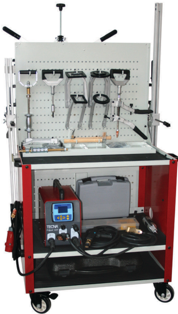
Ausbeulstation CEBOLINER PREMIUM für Arbeiten an Stahlblechen
