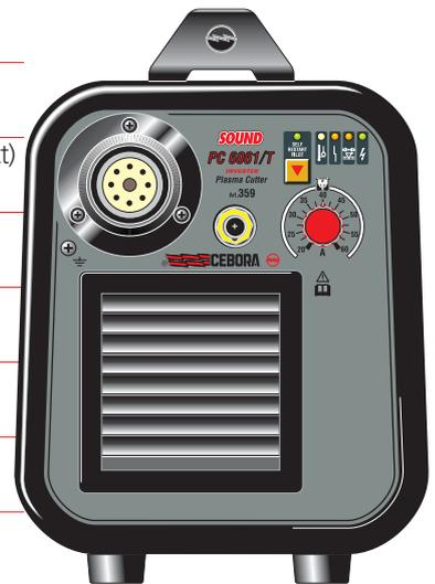
Die neue **POWER PLASMA 6061/T** ist eine dreiphasige Stromquelle zum Plasma-Schneiden von Metall. Dank des neuen manuellen luftgekühlten CP 101 MAR Brenners, liegt die empfohlene Dicke, um die beste Schneidqualität und -produktivität erreichen zu können, bei 20 mm, die maximale Dicke bei 25 mm und die empfohlene Bruchstärke bei 30 mm.
