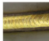
Löten mit CuAl 8 Draht
