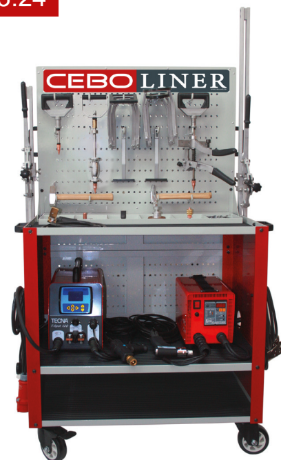
Ausbeulstation CEBOLINER TOPLINE für Arbeiten an Stahl- und Aluminiumblechen
